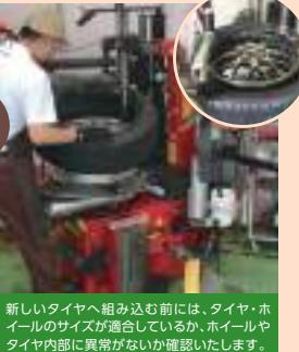
新しいタイヤへ組み込む前には、タイヤ・ホイールのサイズが適合しているか、ホイールやタイヤ内部に異常がないか確認いたします。
